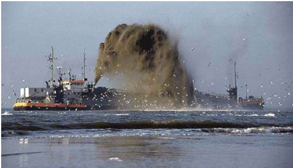
Bilde 6: Sugemudrer som legger til sand under havoverflaten for å hindre erosjon.
